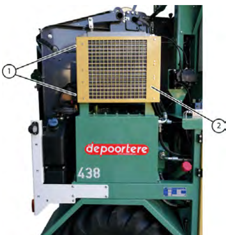
Fig. 109: Nettoyer les radiateurs de la clim et de l'huile hydraulique
