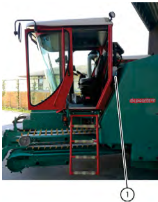
Fig. 111: Réservoir du liquide de lave-glace
