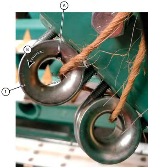
Fig. 119: Usure d'un guide ficelle
