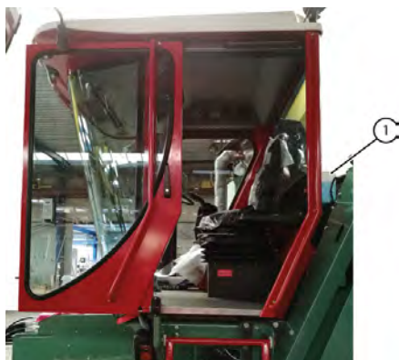
Fig. 15: Réservoir du liquide de lave-glace
